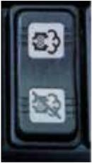
Il sistema di pulizia è completamente automatico. Se la pulizia non è portata a termine per più volte verrà richiesta una rigenerazione manuale con un segnale visivo e acustico. La rigenerazione manuale si esegue fermando la macchina e premendo il relativo pulsante.
