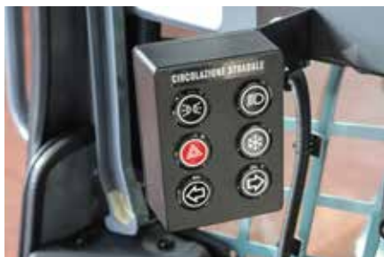
PULSANTIERA CIRCOLAZIONE STRADALE
