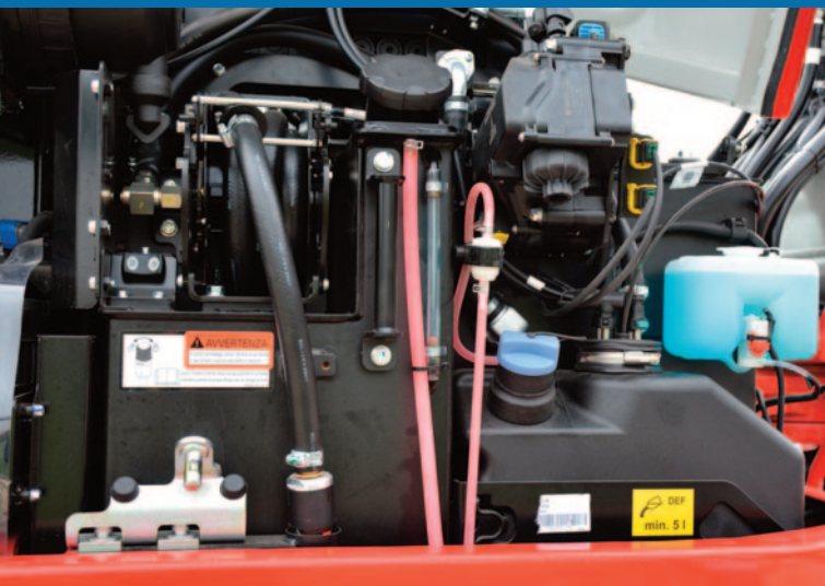
Pompa rifornimento con tubo oautoavvolgente
