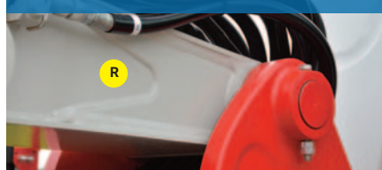
Rinforzi alla base del braccio
