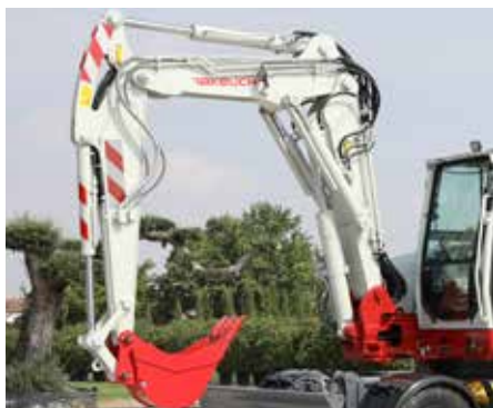
CATARIFRANGENTI BICOLORE SUL BRACCIO
