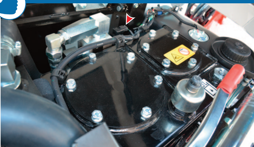
Serbatoio metallico e filtri olio a immersione
