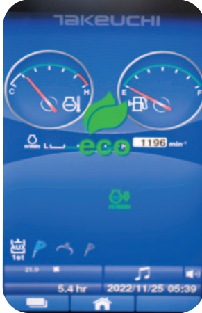
HOME PAGE Sopra la schermata principale, che riassume le info principali. Quando si seleziona una funzione compare l'icona popup.
