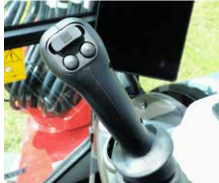
Manipolatore destro con clacson e deceleratore a pulsante. Con il grilletto posto dietro è possibile attivare la seconda velocità.
