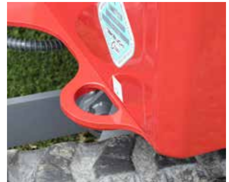
4 anelli di ancoraggio per il trasporto della macchina .
