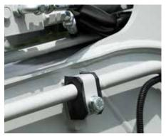
Linee idrauliche in acciaio e morsetti di sostegno in gomma / metallo.
