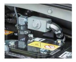
Il selettore 1-2 vie è posizionato sopra il serbatoio olio idraulico.
