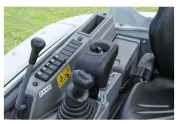
Comandi: fari, deceleratore, modalità Standard o Eco / Montagna e funzionamento a scatto, acceleratore a ghiera, scalda / raffredda porta bottiglie e leva lama dozer.
