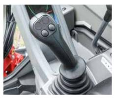
Manipolatore destro con clacson e deceleratore a pulsante. Con il grilletto posto dietro è possibile attivare la seconda velocità.
