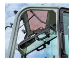
Vetro superiore frontale con apertura a scomparsa, dotato di un meccanismo più ergonomico di apertura/chiusura e tettuccio antiriflesso con tendina parasole di serie.
