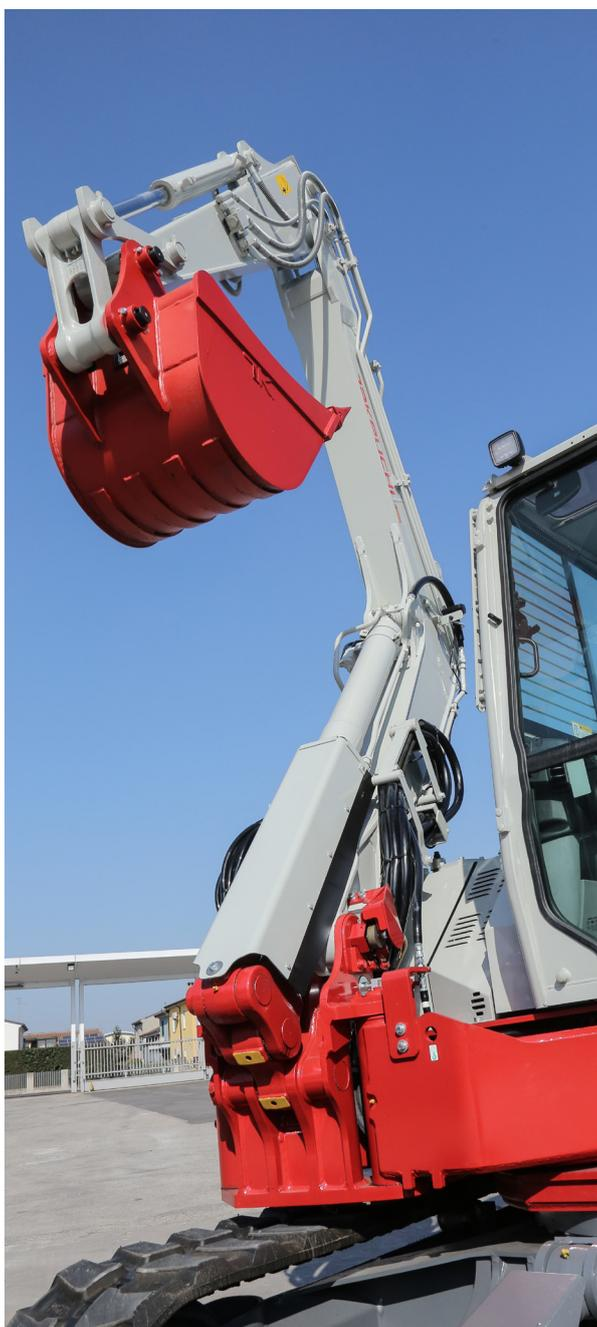
Talvolta può essere necessario utilizzare benne più larghe di 1 metro. In questi casi il bordo della benna andrebbe ad urtare contro la cabina quando il cilindro del braccio di sollevamento è tutto esteso (posizione S) e quando il brandeggio è tutto a destra. All'avvio della macchina il sistema anti-interferenze AIPS Takeuchi impedisce di portare il braccio accanto alla cabina per evitare qualsiasi inconveniente, anche se si monta una benna inferiore a un metro.
