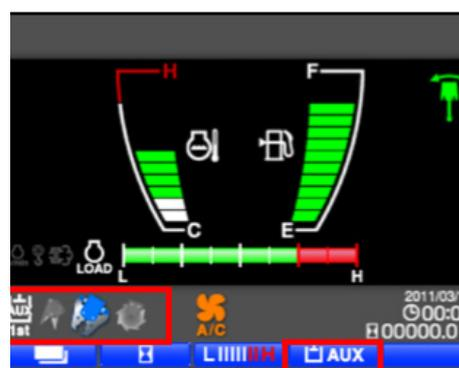
Le configurazioni memorizzate sono richiamabili rapidamente dal menu iniziale premendo il tasto AUX. Selezionando il simbolo scelto, il sistema darà la portata di olio precedentemente memorizzata (di default: No.1 100%; No.2 75%; No.3 50%)
