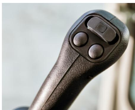
Manipolatori con attivazione delle linee idrauliche ausiliarie di tipo ON-OFF e proporzionale.
