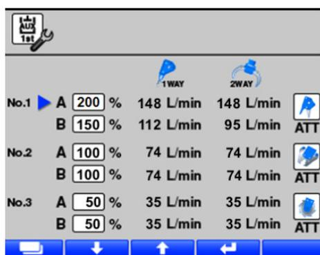
Tramite il computer di bordo è possibile aumentare o diminuire la quantità di olio al sistema ausiliario. È possibile memorizzare fino a tre configurazioni, richiamabili rapidamente dal menu iniziale
