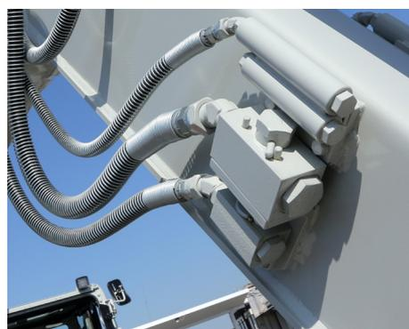
Rubinetti all'uscita dell'impianto ausiliario per evitare spillamenti e perdite di pressione in fase di installazione / disinstallazione attrezzature.
