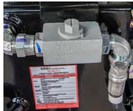
Rubinetto di selezione dell'impianto ausiliario da doppio effetto (pinza) a singolo effetto (martello, trincia) permette di passare dalla modalità singolo effetto (martello) alla modalità doppio effetto (pinza).
