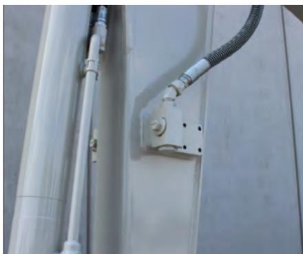
Rubinetti all'uscita dell'impianto ausiliario per evitare spillamenti di olio e garantire facilità di innesto in fase di attacco/stacco delle attrezzature.
