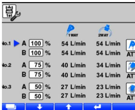
Tramite il computer di bordo è possibile aumentare o diminuire la quantità di olio al sistema ausiliario. È possibile memorizzare fino a 3 configurazioni per il primo ausiliario.
