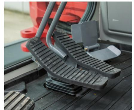
2 velocità di avanzamento. Pedali con rivestimento in gomma che consentono la traslazione senza l'utilizzo delle mani.
